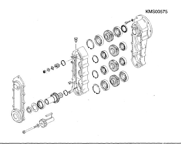
ASSEMBLING 4-SPEED REDUCTION GEAR (TYPE TF 0 GO1 6....)
